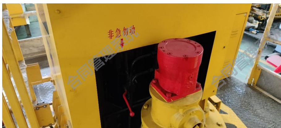
图 2-26 手动急降阀安装示意图
