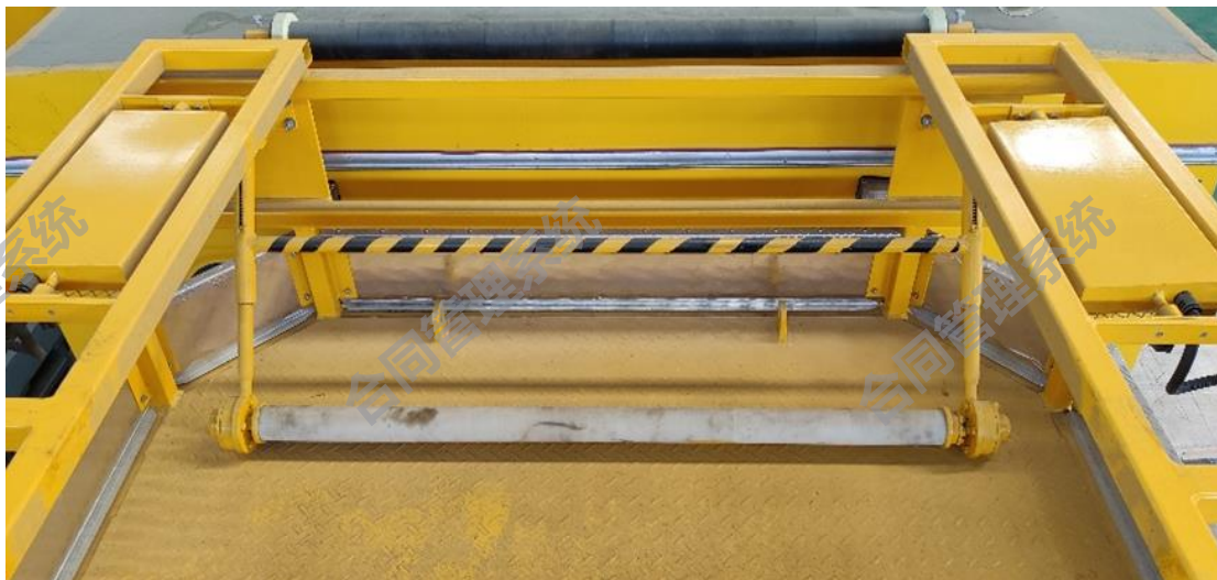
图 2-31 导线支撑装置
